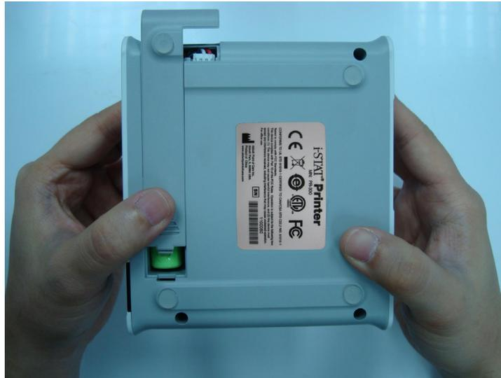
3. Zum Auswechseln einer wiederaufladbaren Batterie die vorhandene Batterie durch vorsichtiges Ziehen an den roten/weißen/schwarzen Kabeln vom Gerät trennen, bis sich der Stecker von den drei metallenen Kontaktstiften löst. Die vom Gerät getrennte Batterie aus dem Batteriefach entnehmen.
