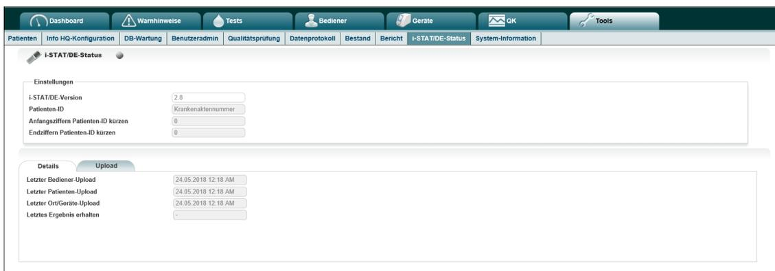
Allgemeine Informationen zur Verbindung mit i-STAT/DE werden zusammen mit einer Statusanzeige oben links auf dem Bildschirm angezeigt. Grün zeigt an, dass die Verbindung zwischen Info HQ und i-STAT/DE ordnungsgemäß funktioniert. Rot zeigt an, dass bei der Verbindung zu i-STAT/DE ein Problem aufgetreten ist.
