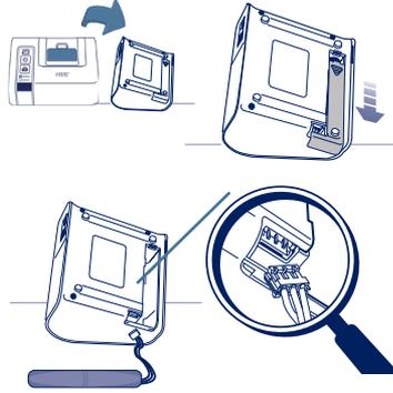
3. Setzen Sie die wiederaufladbare Batterie ein und schließen Sie das Batteriefach.
