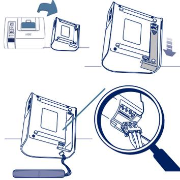
3. Inserire la batteria ricaricabile e chiudere
