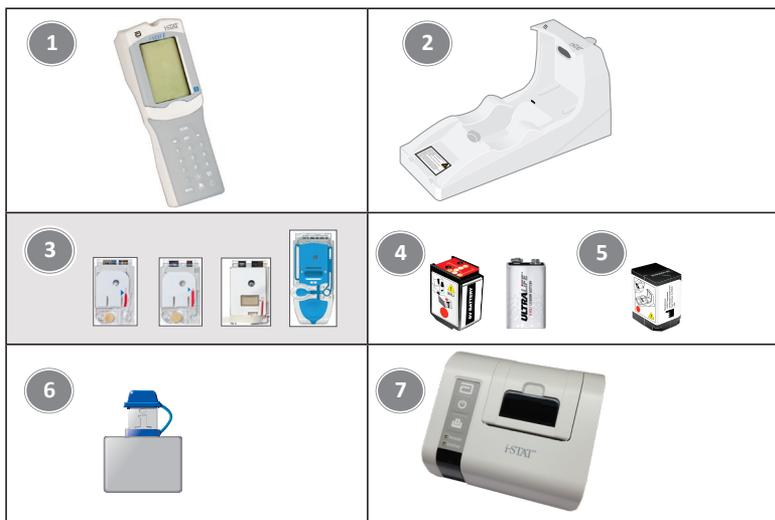
1. **i-STAT 1 Analyzer:** utilizzato per eseguire test con la cartuccia, esaminare i risultati dei test ed eseguire test di controllo qualità (CQ). Funzionalità opzionale per la trasmissione dei risultati con configurazione di connettività di rete tramite i-STAT 1 Downloader/Recharger.
