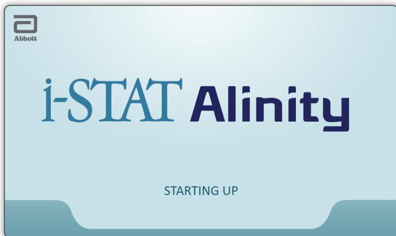
Nachdem Sie das Instrument mit dem Ein-/Aus-Schalter eingeschaltet haben und die Startsequenz beginnt, leuchtet die LED grün, und „i-STAT Alinity“ wird kurz im Display angezeigt. Während der Einschaltsequenz führt das i-STAT Alinity-Instrument eine Reihe von Selbsttests durch.
